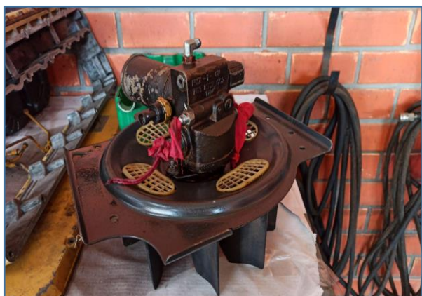
VENTILADOR DANIFICADO JÁ RETIRADO DO EQUIPAMENTO, PORÉM AINDA MONTADO
