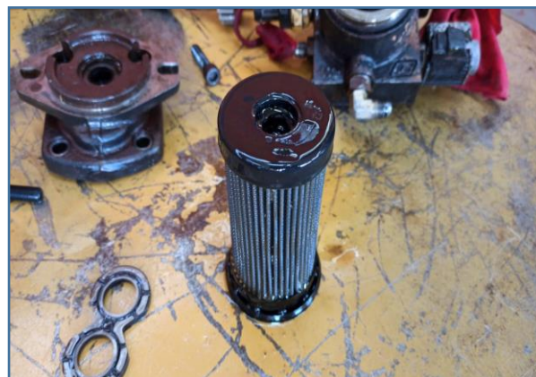
FILTRO DO ÓLEO DO VENTILADOR A SER SUBSTITUÍDO
