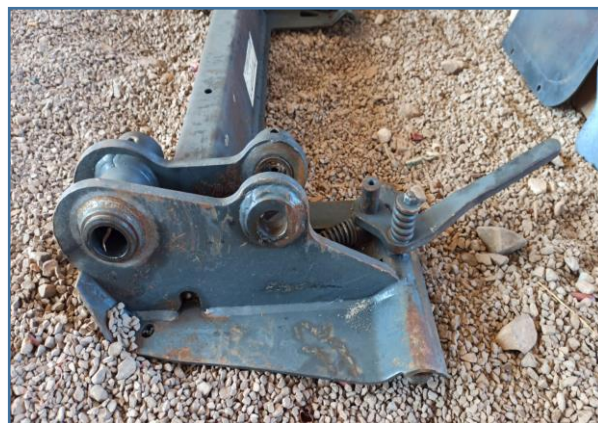
BOB TACH FRONTAL JÁ DESMONTADO – POSSUI TODO O EMBUCHAMENTO DANIFICADO
