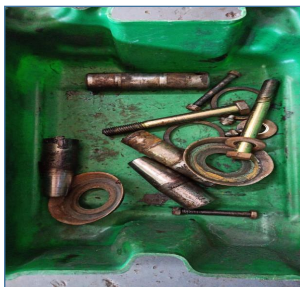
VÁRIOS PINOS DANIFICADOS JÁ DESMONTADOS
