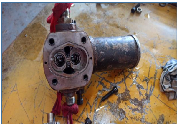
PARTE INTERNA DO VENTILADOR JÁ DESMONTADO – DETALHE DO LOCAL QUE HÁ DESGASTE
