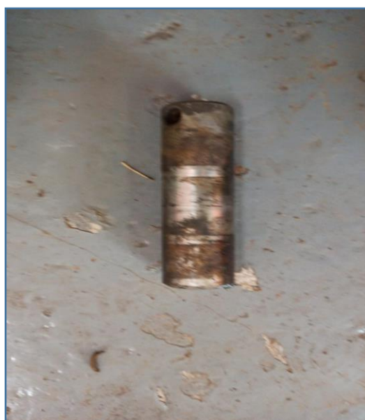
BOB TACH FRONTAL JÁ DESMONTADO – POSSUI TODO O EMBUCHAMENTO DANIFICADO
