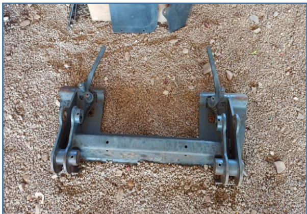
BOB TACH FRONTAL JÁ DESMONTADO – POSSUI TODO O EMBUCHAMENTO DANIFICADO
