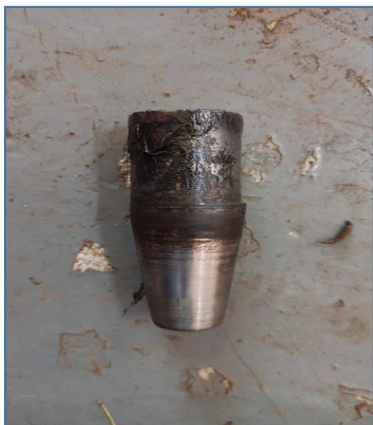
BOB TACH FRONTAL JÁ DESMONTADO – POSSUI TODO O EMBUCHAMENTO DANIFICADO
