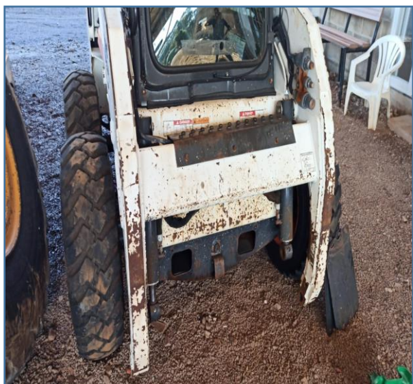
EMBUCHAMENTO DIANTEIRO ESTÁ DANIFICADO
