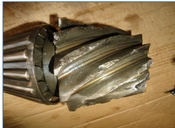
DETALHE DO PINHÃO DANIFICADO
