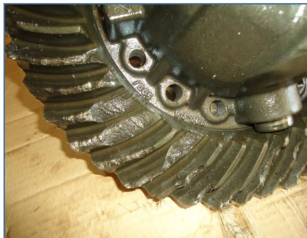
DETALHE DA COROA DANIFICADA
