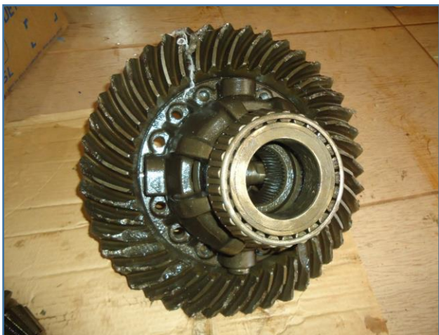
COROA E ROLAMENTO DANIFICADO
