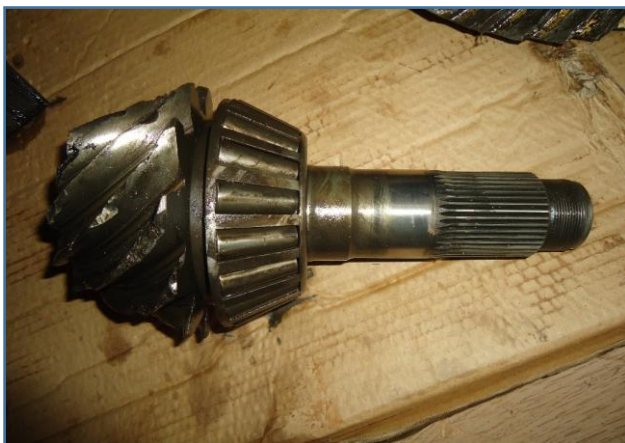
PINHÃO E ROLAMENTO DANIFICADO
