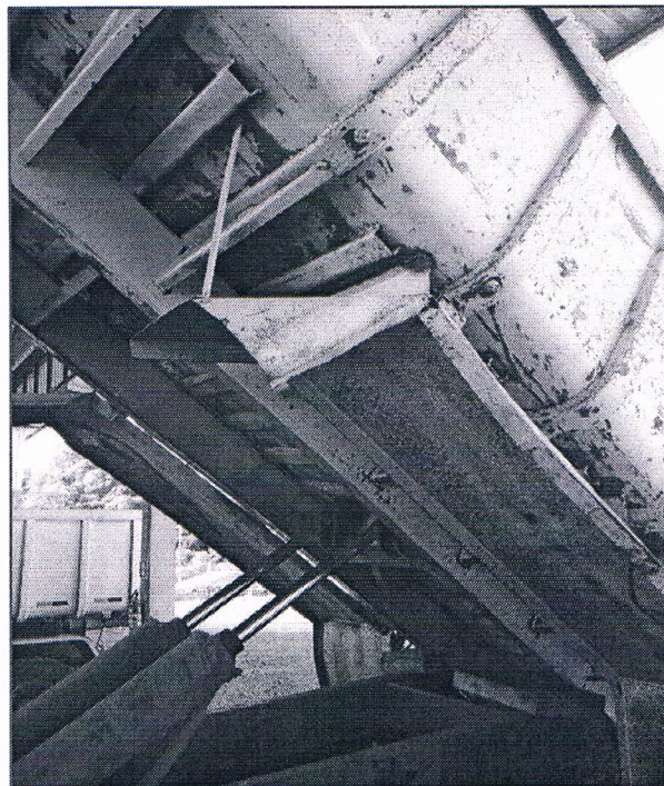
CAÇAMBA POSSUI AVARIAS
