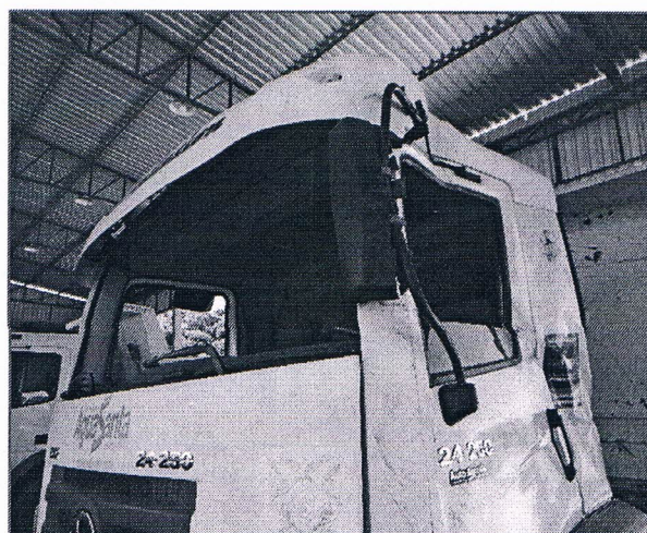
IMAGEM COM DETALHE DO PÁRA-BRISA E ESPELHO QUEBRADOS, PORTA E MOLDURAS AVARIADAS
